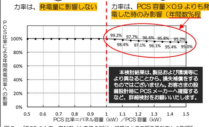
\* 大規模太陽光発電システム導入のための検討支援ツール (STEP-PV: NEDO) を用いて、弊社エリア1地点をシミュレーションした検討例 (PCS比率による年間発電効率への影響: 力率100%での発電出力/力率90%での発電出力)
