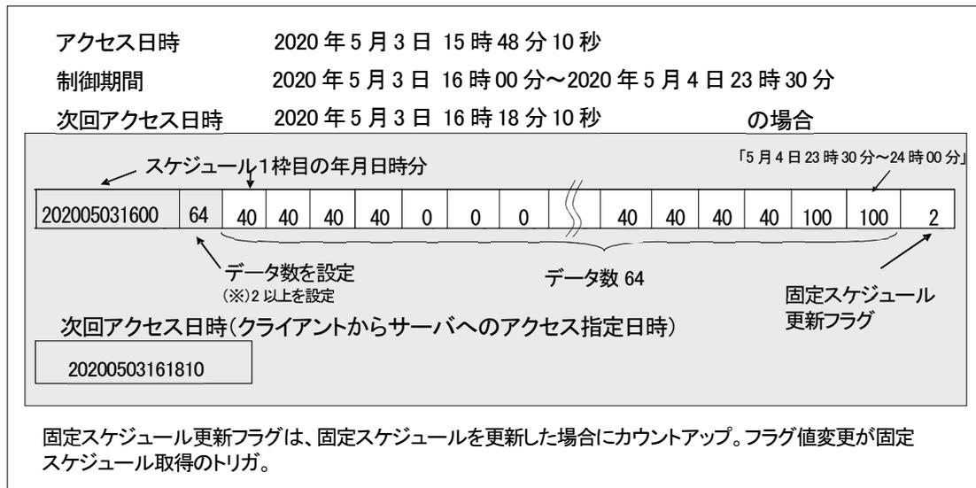
図 8.4 更新スケジュールのデータ構造
