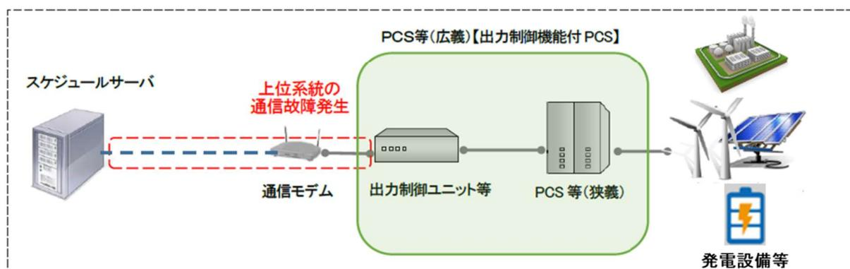
図 7.3 上位システムの通信故障
