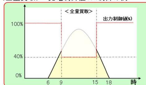
図 4.4 余剰買取制御 太陽光発電の例
