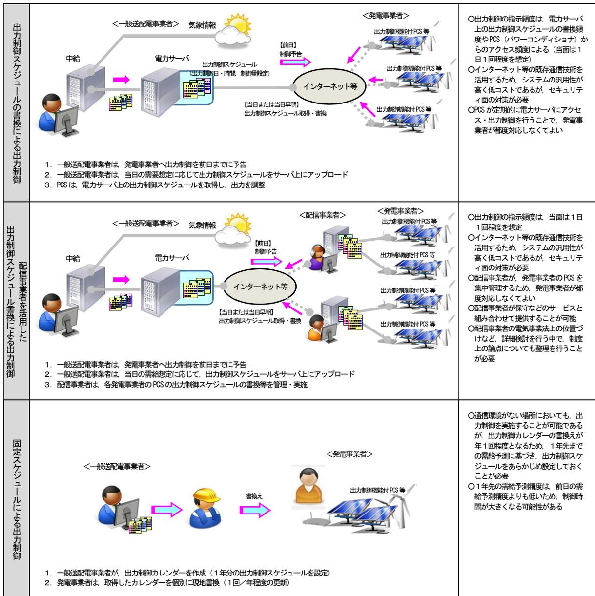
図 2.1 出力制御システムの概要
