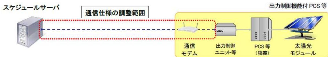
図 8.8 通信仕様の調整範囲 ※太陽光発電の場合
