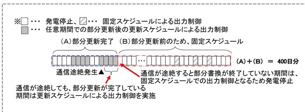
図 7.4 通信途絶時の出力制御イメージ
