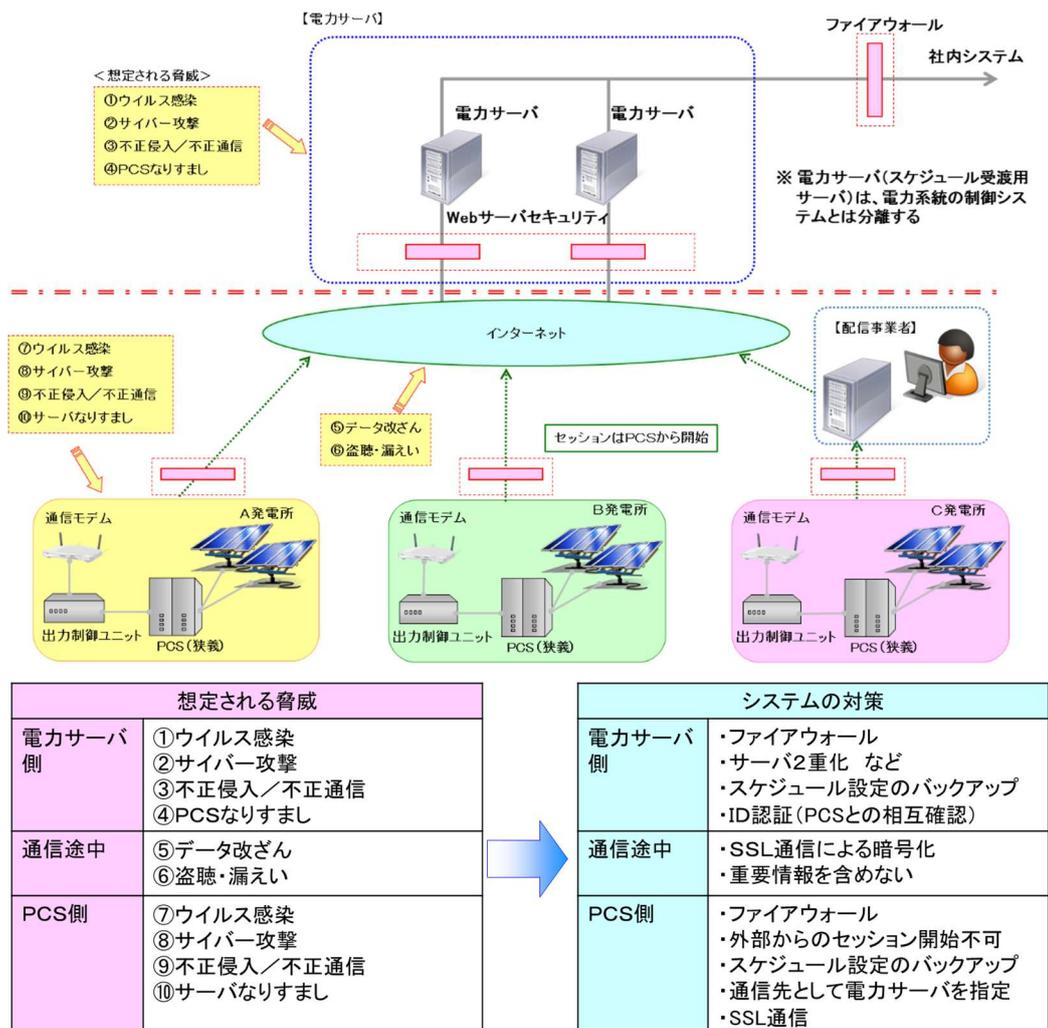
図 5.1 出力制御システムに想定される脅威と対策
