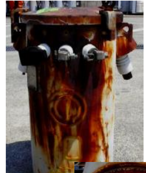
変圧器底面に油にじみ発生
