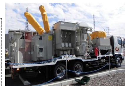
移動式変電所 (変圧器車イメージ)
