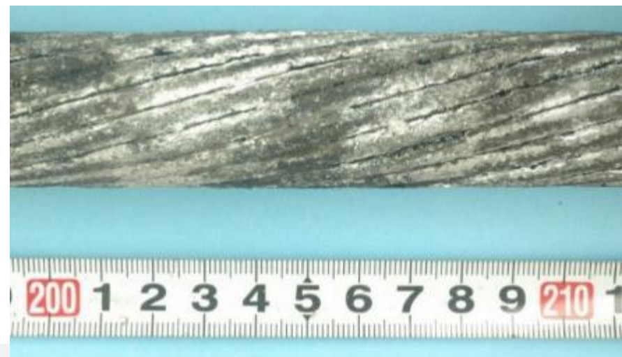
【電線の腐食（外観）】
