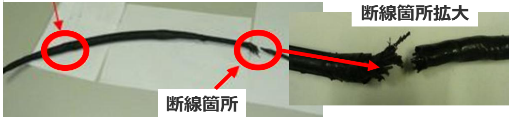
電線接続箇所の劣化
