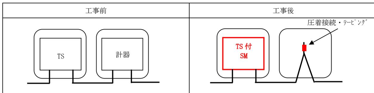
例⑦：タイムスイッチ機能付 SM 設置済で既設計器部分に計器素通し機器\*が設置されている場合で増減設等によりタイムスイッチ機能付 SM を取替るときは、計器素通し機器\*の撤去および幹線の接続もしくは幹線の張替を実施します。
