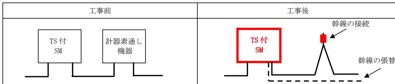
※ 検満工事等において、素通し工事を実施する場合、既設計器部分に圧着工事の代替として使用する機器。
