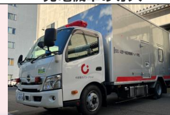
発電機車の導入
