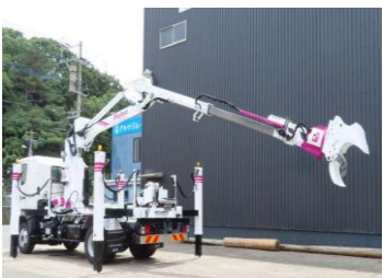
伐採作業の機械化 (フェラーバンチャ車両)
