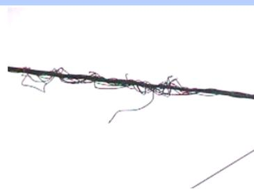
竜巻による電線の一部損傷
