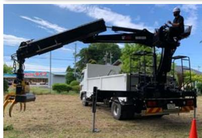
倒木伐採等において、樹木の吊上げと切断が可能となるクレーン・把持部を装備しており、安全に倒木処理を実施するために導入します
