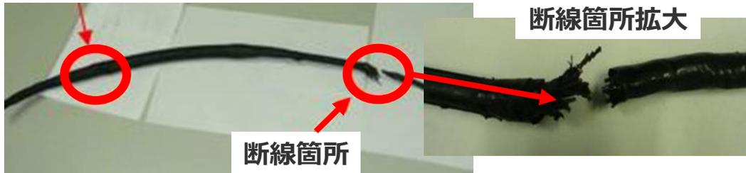
電線接続箇所の劣化
