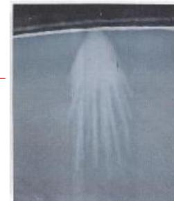
水トリー劣化により絶縁破壊が生じたケーブル
