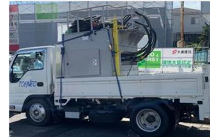
車両後部に変圧器が積載されており、変圧器以下の仮送電が可能で、変圧器取替工事を無停電で実施する際に使用します
