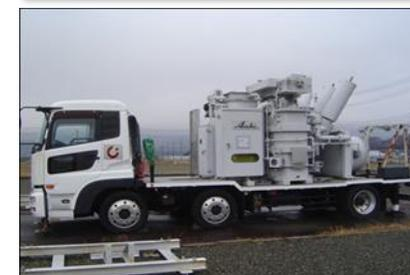
配電用変圧器や変電所が積載された車両で、配電用変電設備の取替や変電所の故障等で使用します
